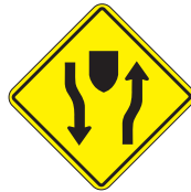
Route à chaussées séparées 24" x 24" SD266
